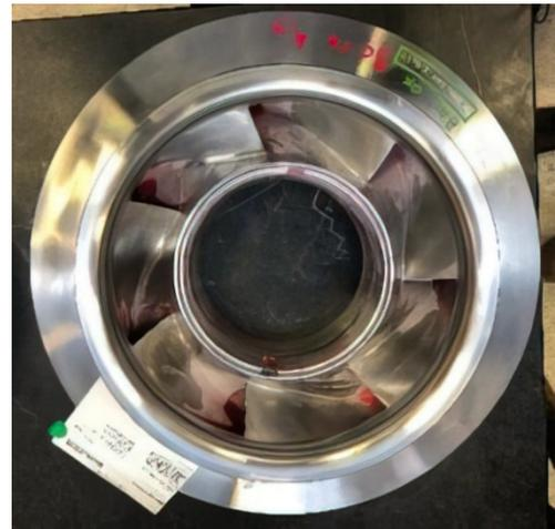
**Рис. 9.** Проверка капиллярным методом неразрушающего контроля
