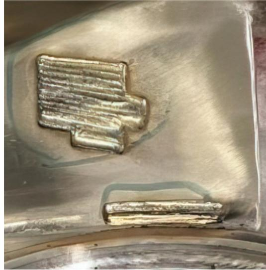
**Рис. 7.** Результаты наплавки
