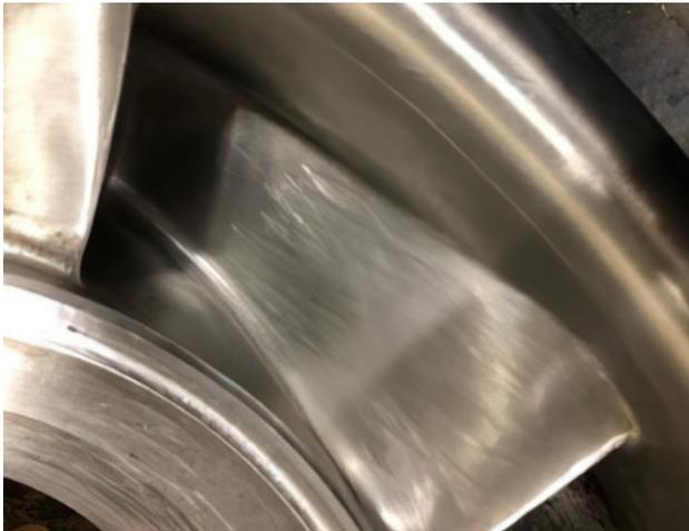
**Рис. 8.** Шлифование поверхности и восстановления геометрии
