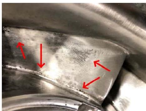
**Рис. 2.** Износ лопаток рабочего колеса
