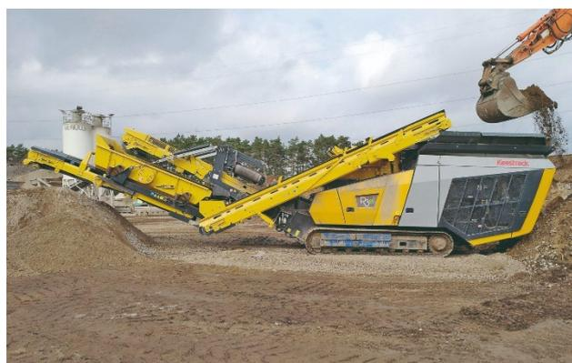
Рис. 7. Мобильная роторная дробилка Keestrack R3e
