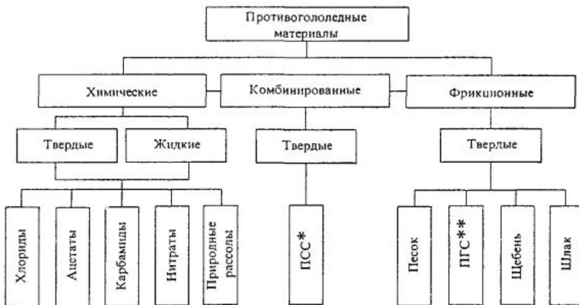
Рис. 2. Обобщенная схема классификации противогололедных материалов
