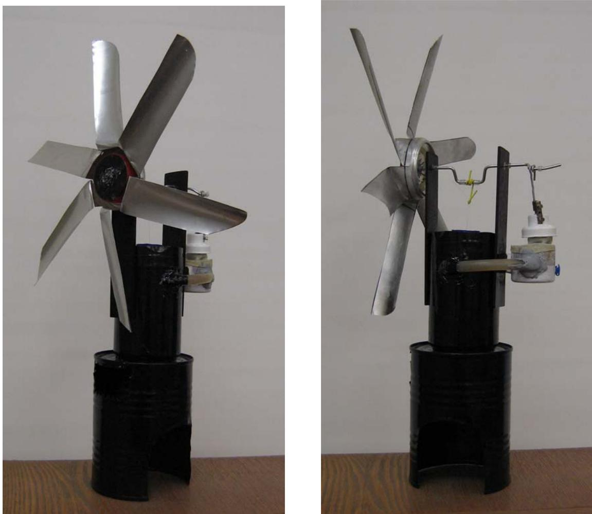
Рис. 2. Лабораторная модель двигателя Стирлинга
